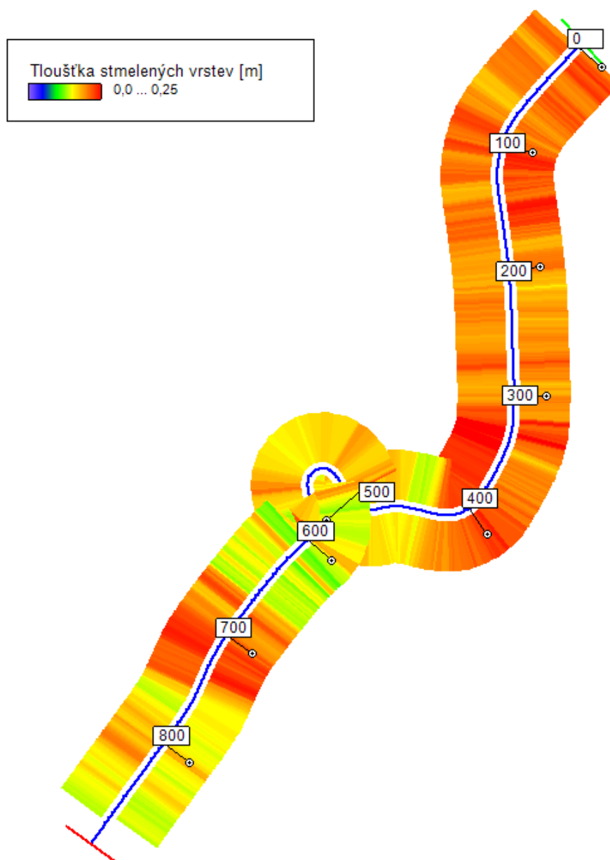
Obrázek 6. Tloušťka stmelených vrstev úseku na mapě. Červená místa znázorňují sekce, kde tloušťka stmelených vrstev je vyšší než 25 cm.
